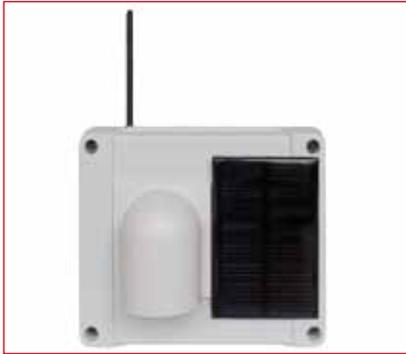
Der neue Funk-Außensensor arbeitet stromsparend aus einem Akku. Dieser wird von einer kleinen Solarzelle nachgeladen. Somit ist ein langfristiger, netzunabhängiger Betrieb gewährleistet! Das Sendefunkmodul ist bereits im Funk-Außensensor integriert. Ein zusätzliches Empfangsmodul ist nicht notwendig, da dieses bereits in der 100-728 integriert ist.
