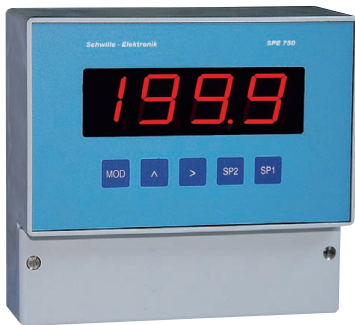
Programmierbarer Anzeigewert zur Meßgröße Ein programmierbarer Relaischaltpunkt Beleuchtete Dimensionsanzeige rot: °C Sensorversorgung: 24V/30 mA
